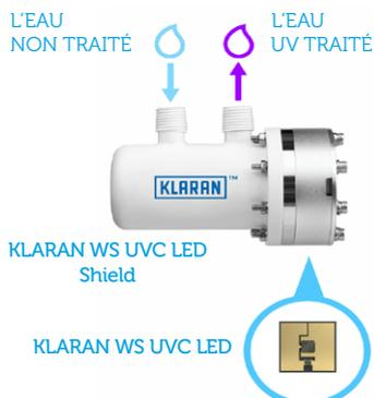
Lorsque l'eau du réservoir de détente directe passe à travers le Klaran shield pour se rendre au robinet, elle est exposée à un rayonnement LED UVC qui détruit les bactéries et les virus présents dans l'eau.
