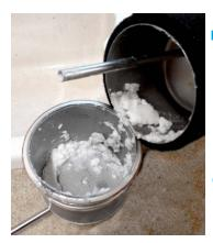
Un réservoir d'eau chaude peut s'entartrer en un temps relativement court, en fonction de la dureté de l'eau, de la température de l'eau chaude et de la fréquence d'utilisation.
