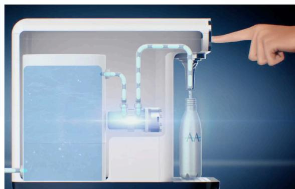
Le "Klaran Shield" consiste en une petite chambre à travers laquelle l'eau s'écoule du réservoir de détente directe vers le robinet. Sur son chemin, l'eau est exposée à un rayonnement LED UVC de longueur d'onde qui est très efficace pour détruire les bactéries et les virus d'origine hydrique.
